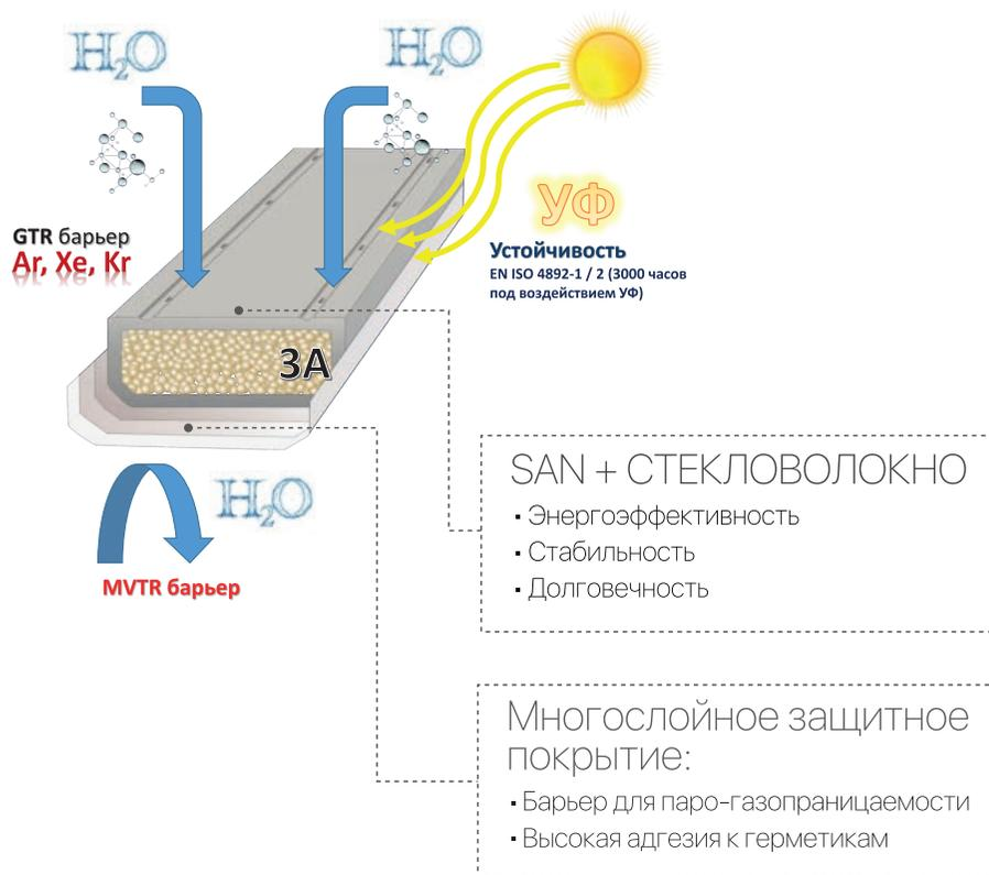
MULTITECH – это дистанционная рамка последнего поколения, которая была разработана инженерно-исследовательскими лабораториями компаний ALU PRO и ROLLTECH. Инновационный материал рамки выполнен из сополимерного композита армированного стекловолокном. Многослойное полимерное покрытие рамки служит барьером газо-влагопроницаемости.
